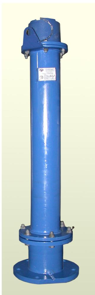
Гидрант предназначен для отбора воды на пожарные нужды, протекающей в системе холодного водоснабжения при температуре от плюс 5 до плюс 50°C и давлении до 1,6МПа(16кгс/см<sup>2</sup>).
