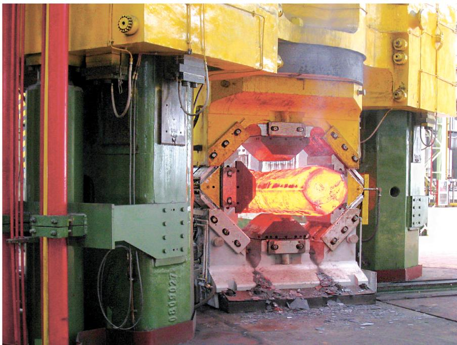
Четырехбойковые ковочные устройства предназначены для четырехсторонней радиальнойковки на гидравлических ковочных прессах силой до 125 МН.
