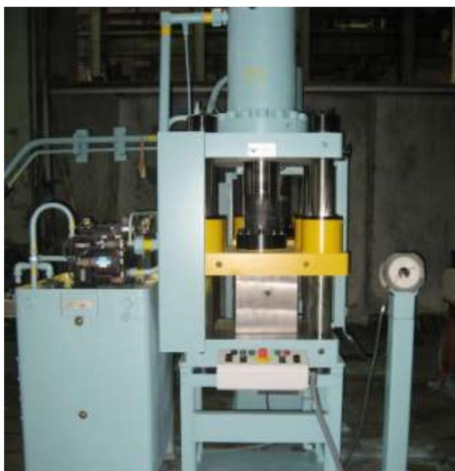
Прессы гидравлические 4-х колонные повышенной точности движения ползуна параллельно плоскости стола и перпендикулярности хода ползуна к плоскости стола предназначены для прессования различных изделий.
