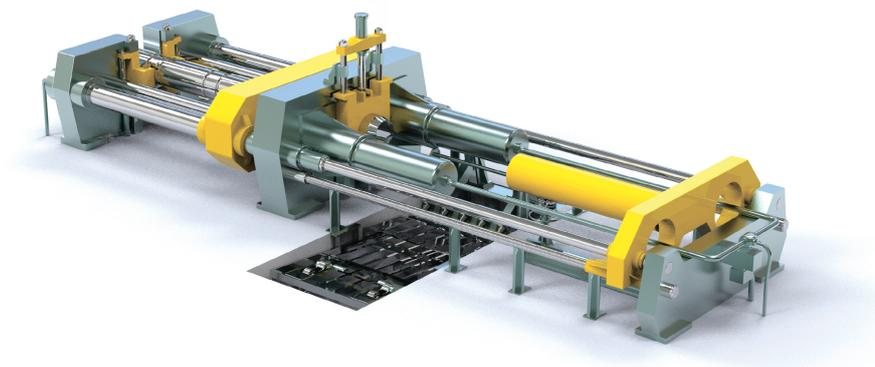
Прессы гидравлические горизонтальные предназначены для изготовления крутоизогнутых отводов диаметром от 40 мм до 1200 мм методом протяжки из труб-заготовок в нагретом состоянии в условиях специализированных производств.
