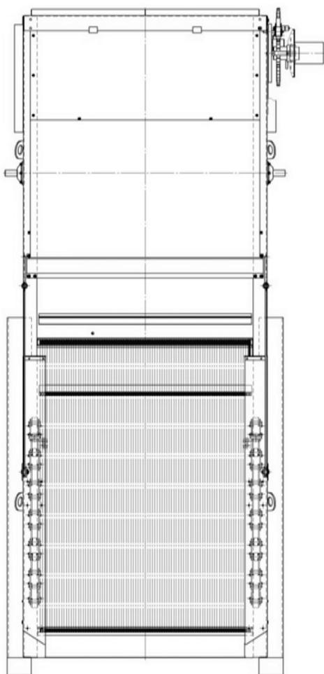
Решетка сорозадерживающая с механизированным приводом модели PC1800x2500 предназначена для задержания и непрерывного извлечения из сточной воды грубодисперсных примесей на городских очистных сооружениях, канализационных насосных станциях.
