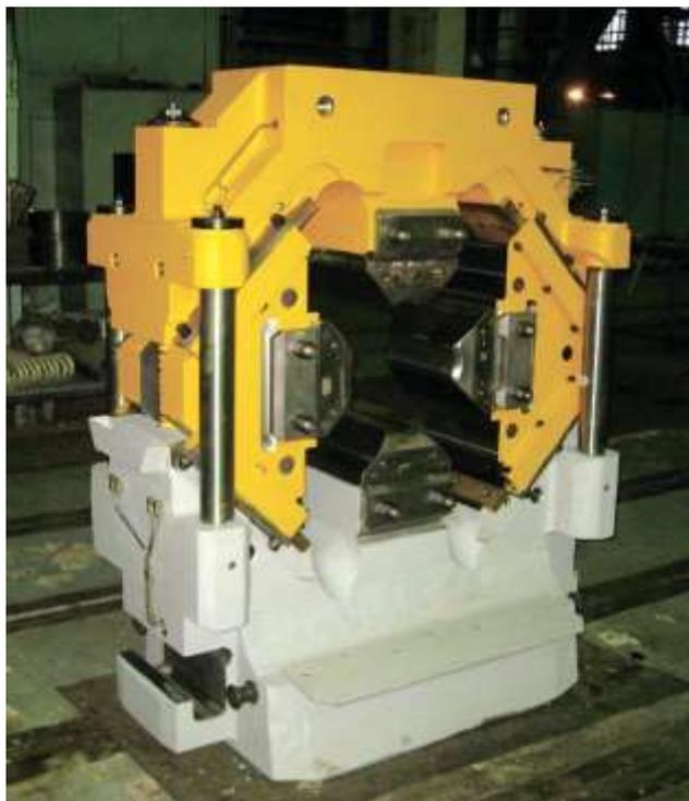
Ковочные устройства могут быть оснащены водяной системой охлаждения бойков и узлов трения. Системы охлаждения и смазки позволяют четырехбойковому ковочному устройству работать длительное время без перегрева узлов трения с минимальным износом рабочих поверхностей бойков.
